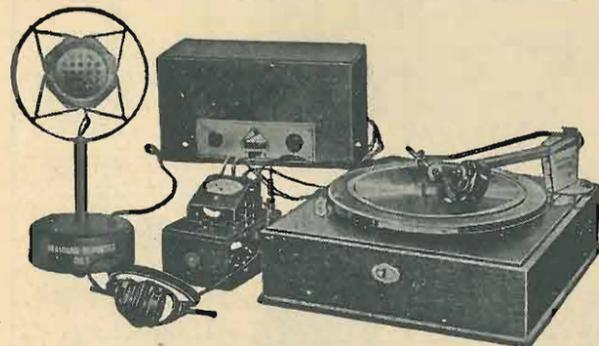
dizioni sono già state effettuate e hanno suscitato una piacevole sorpresa per l'ottima qualità, che finora si era ritenuta impossibile raggiungere. La logica divisione in tre parti del procedimento di fabbricazione — incidere il disco tenero, indurirlo, riprodurlo quando è indurito — permette
